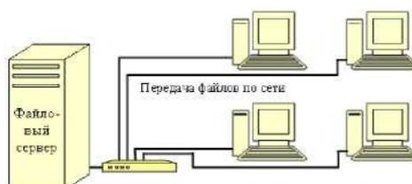
**Рис.1.** Схема работы с БД в локальной сети с выделенным файловым сервером (трехуровневая архитектура).
